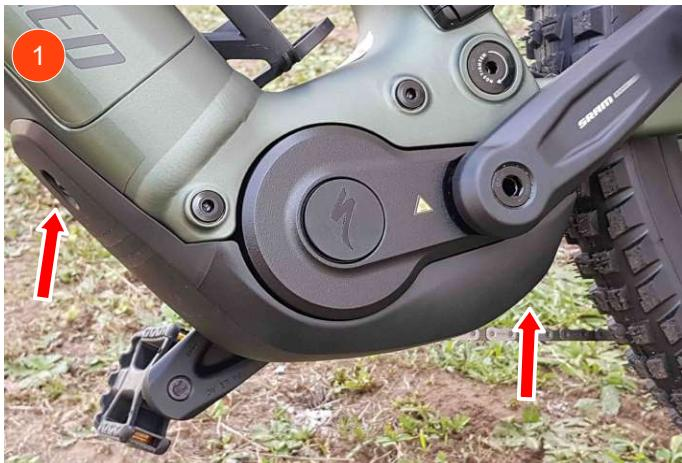
Svitare le viti indicate dalle frecce rosse e rimuovere la protezione in plastica che ripara il motore.
