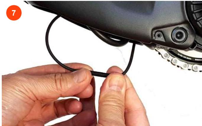
Individuare il connettore che collega il sensore di velocità al motore.
