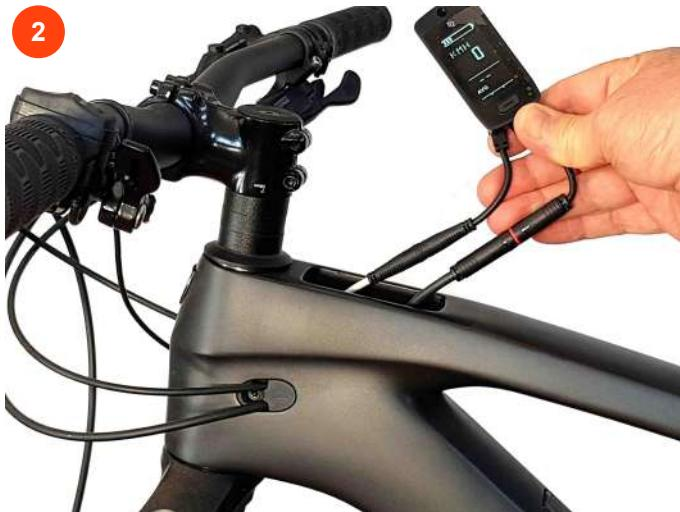
Estrarre il display rimuovendo la vite centrale che lo fissa al telaio.
