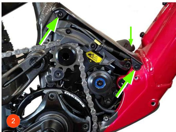
Rimuovere le 3 viti indicate dalle frecce (una delle quali si trova sul lato opposto accanto alla presa di ricarica) e rimuovere la protezione in plastica superiore.
