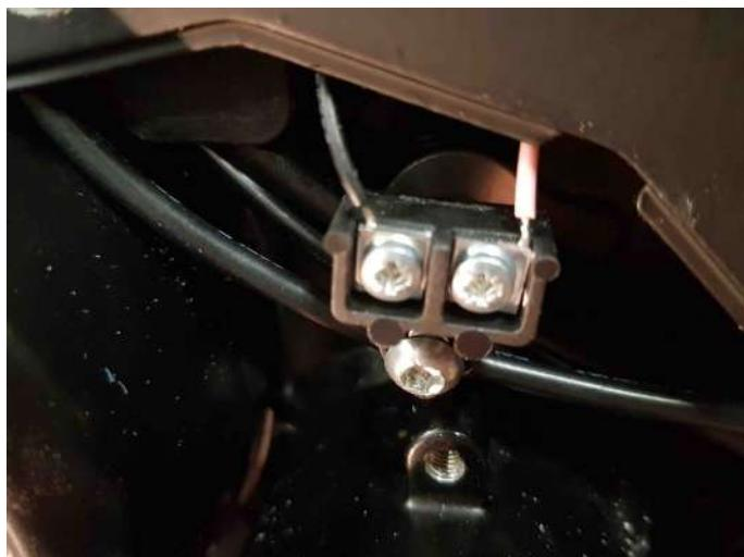
Cercare nella parte sottostante il connettore a due poli, bianco, proveniente dal sensore di velocità.
