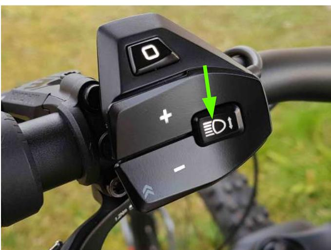
Lo sblocco di velocità si ottiene con una rapida pressione del tasto Luce. Sul display appare il simbolo LUCE.
