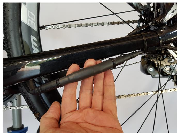
Fissare opportunamente il dispositivo al telaio. Far entrare il filo in eccesso dentro al telaio.
