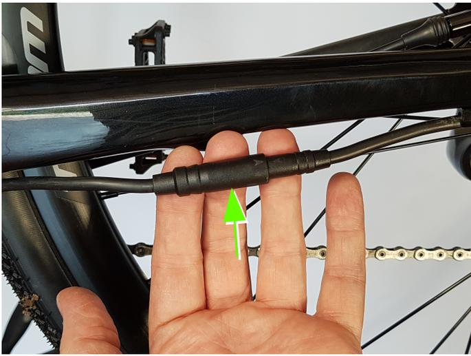
Identificare il connettore posto sul cavo che collega il motore alla batteria
