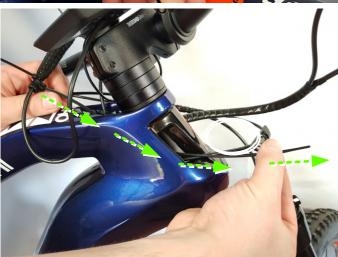
Infilare l'estremità della fascetta attraverso le due aperture e tirare il "salsicciotto" che contiene il connettore a 6 pin fuori dall'apertura frontale
