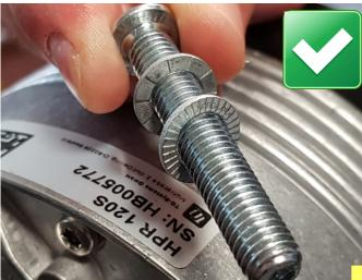
Fissare il motore con le due viti M8.
