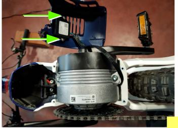
Per comodità di movimento è oppurtuno svitare anche le due viti che fissano il modulo gps al carter. E' necessaria una chiave a brugola da 2 mm.
