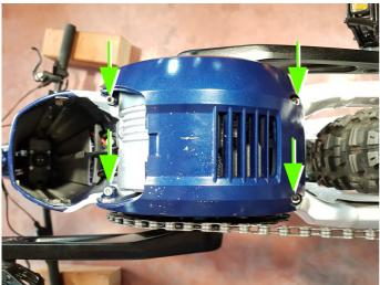
Rimuovere le quattro viti che fissano il carter sotto-motore. E necessaria una chiave a brugola da 4 mm.
