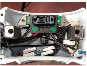
Posizionare tutti i connettori ordinatamente sul fondo dell'alloggiamento motore. Fare in modo che non si sovrappongano altrimenti il motore farà pressione su di essi e non si chiuderà!
