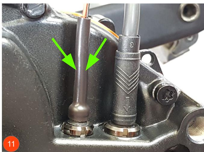
Far scorrere la guaina termorestringente sopra la connessione e scaldare delicatamente con un Phon ad alta temperatura o con una fiamma fino ad ottenere un buon restringimento.
