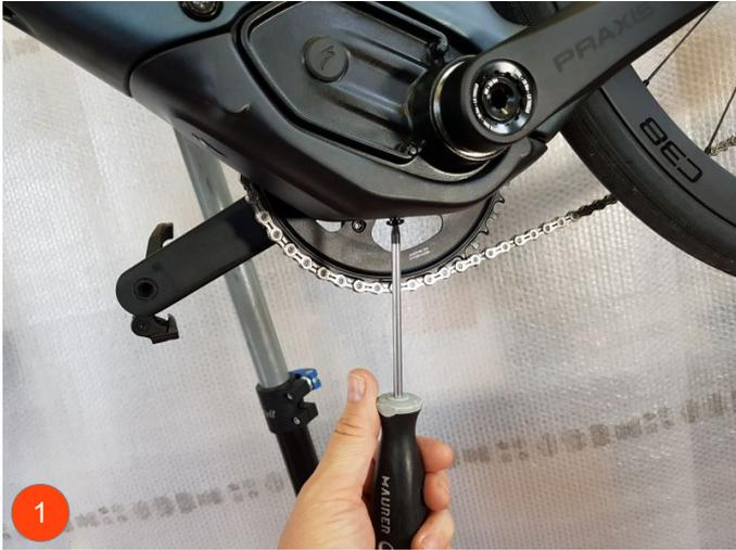
Rimuovere la vite che fissa la protezione sotto-motore
