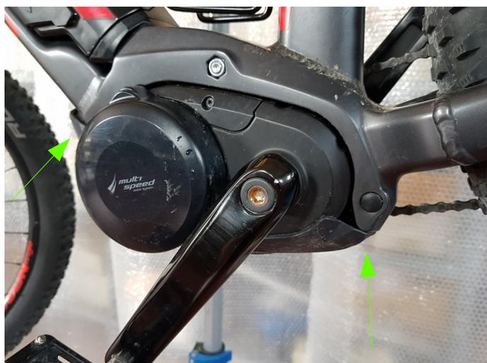
Rimuovere le 4 viti che fissano la protezione inferiore
