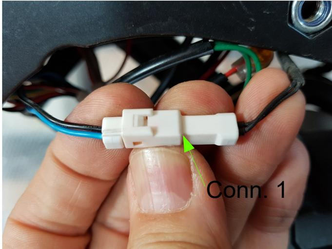
Seguendo il cavetto che proviene dal SENSORE DI VELOCITA' individuare il **Connettore a due poli (1)** che lo collega al motore
