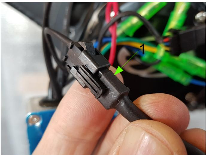
Seguendo il cavetto che proviene dal SENSORE DI VELOCITA' individuare il **Connettore a tre poli (1)** che lo collega al motore
