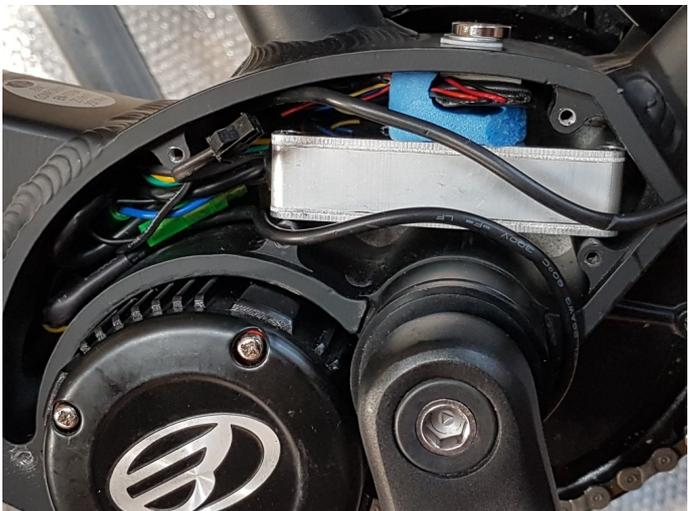
Riporre il dispositivo ordinatamente all'interno del carter motore.
