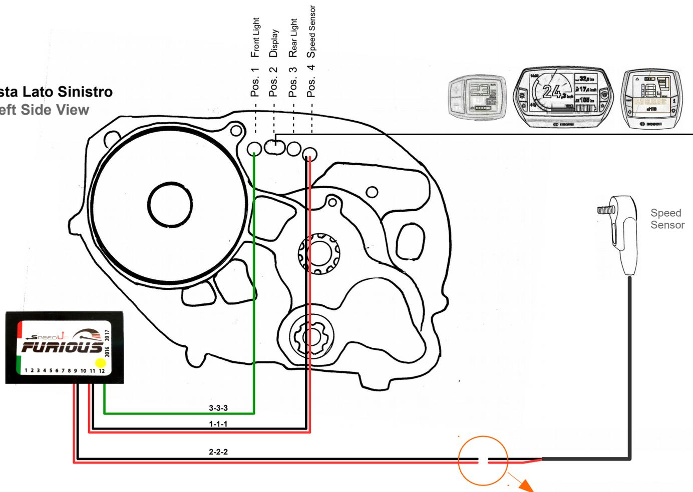
1-1-1 = Cavo a 2 poli con connettore originale Bosch da connettere nel motore (Pos. 4)
