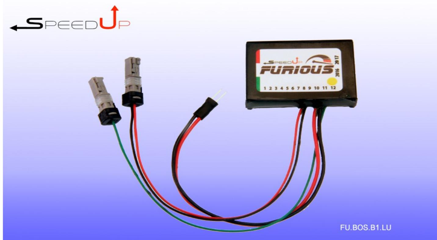
SpeedUp Furious va montato all'interno del carter sinistro del motore Bosch, solitamente in plastica nera/grigio, che serve da protezione per le sedi dei connettori.
