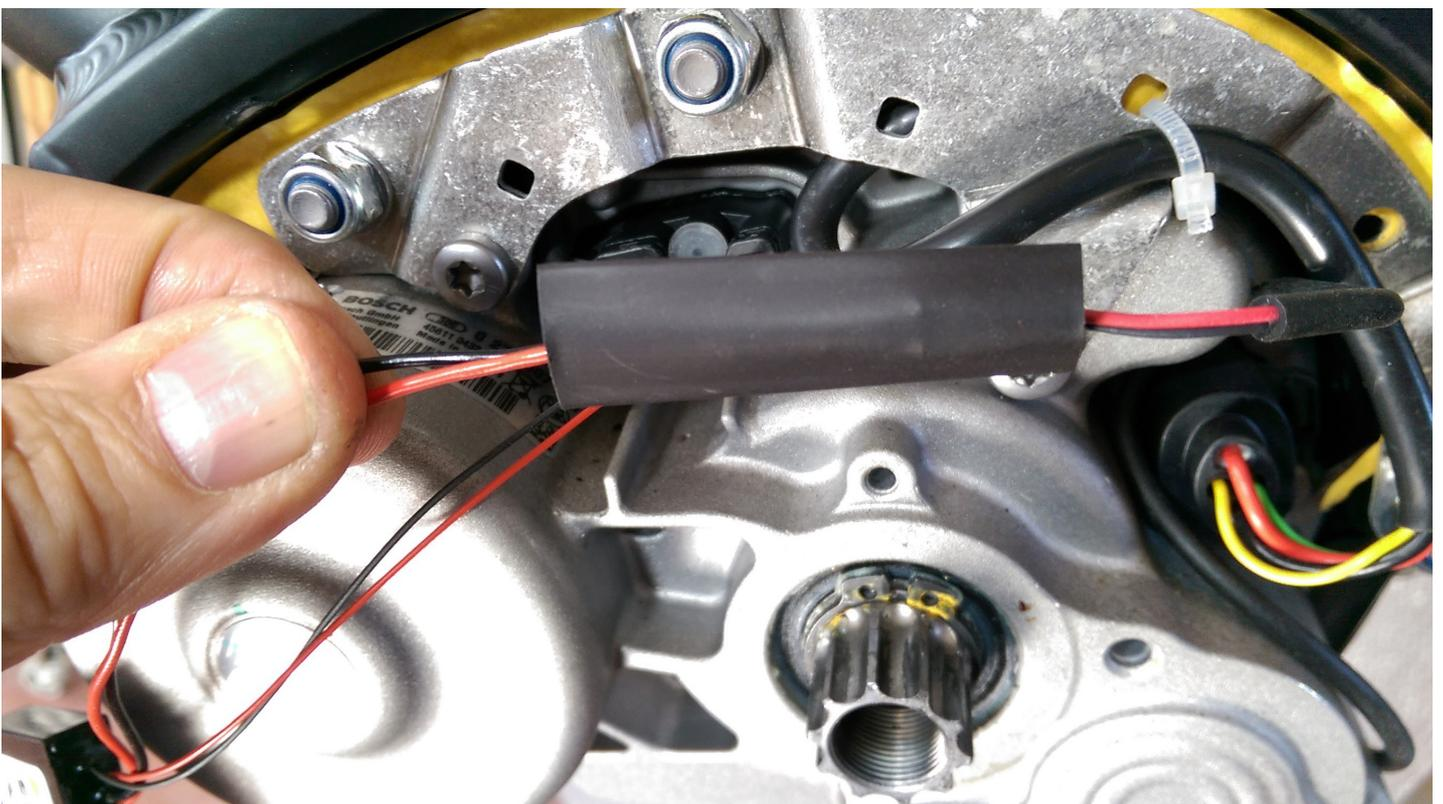
**7 -** Infilare la guaina termoretraibile sopra la connessione e scaldare con un Phon ad alta temperatura oppure con la fiamma di un accendino. MUOVERE la fiamma AVANTI-INDIETRO, ATTENZIONE A NON DANNEGGIARE I FILI!!!
