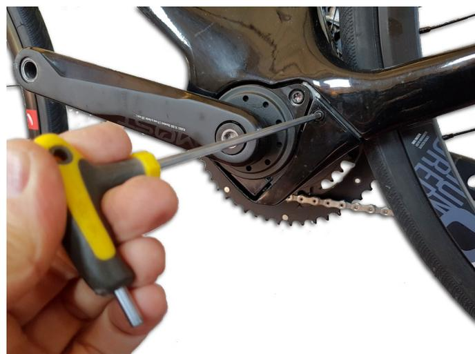
Alcuni modelli di Ebike montano una protezione del gear-box Fazua che è necessario rimuovere:
