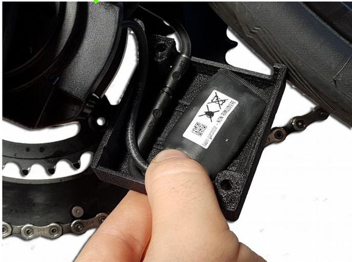
Inserire il dispositivo nel coperchietto con l'uscita dei **CAVI VERSO IL BASSO!!**
