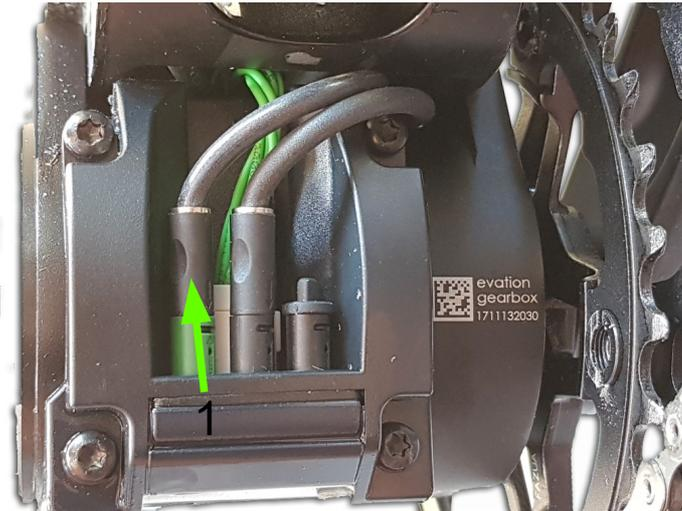
Seguendo il cavetto che proviene dal SENSORE DI VELOCITA' individuare il **Connettore (1)** che lo collega al motore
