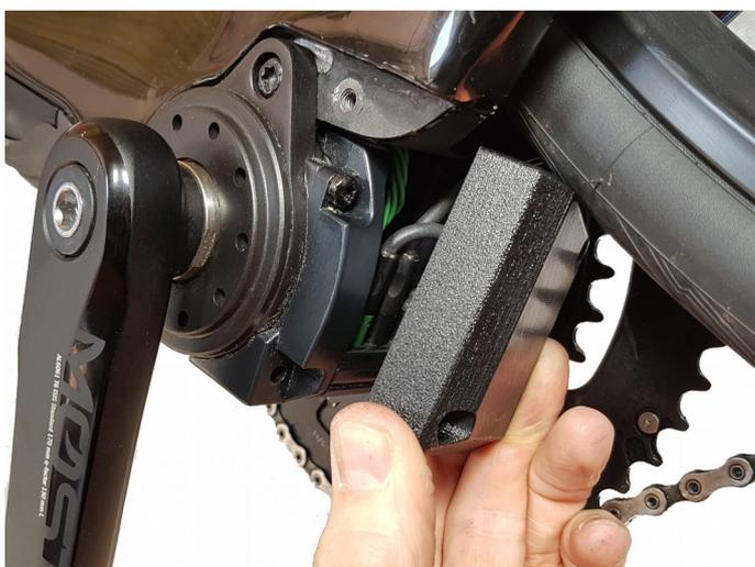
Fissare il coperchietto con le due viti in dotazione.
