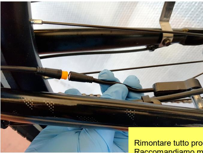
Scollegare il connettore del sensore di velocità
