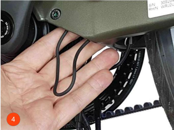
Se cerchiamo bene ci sarà un cavetto sottile nero che proviene da un lato dal sensore di velocità e dall'altro entra nella sommità del motore; dobbiamo raggiungere il connettore che si trova un po' più su. E' necessario abbassare leggermente il motore.
