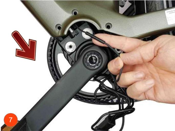
Far scivolare lentamente il motore verso il basso fino a che il connettore sarà raggiungibile. Saranno sufficienti pochi centimetri! Se non scende sarà sufficiente smuovere leggermente i fili "in trazione" agendo dal vano batteria.
